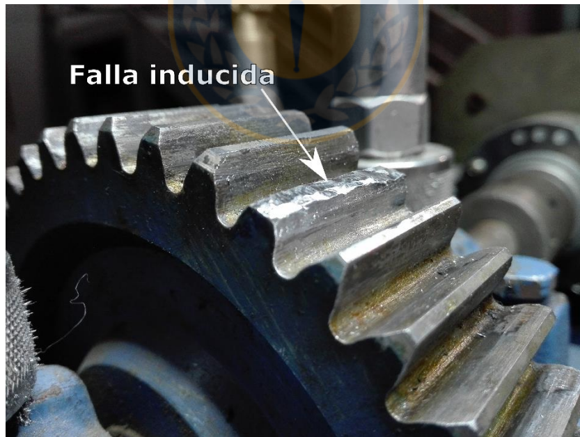
Figura B.2. Defecto inducido en diente de la corona. Fuente: Elaboración propia.
