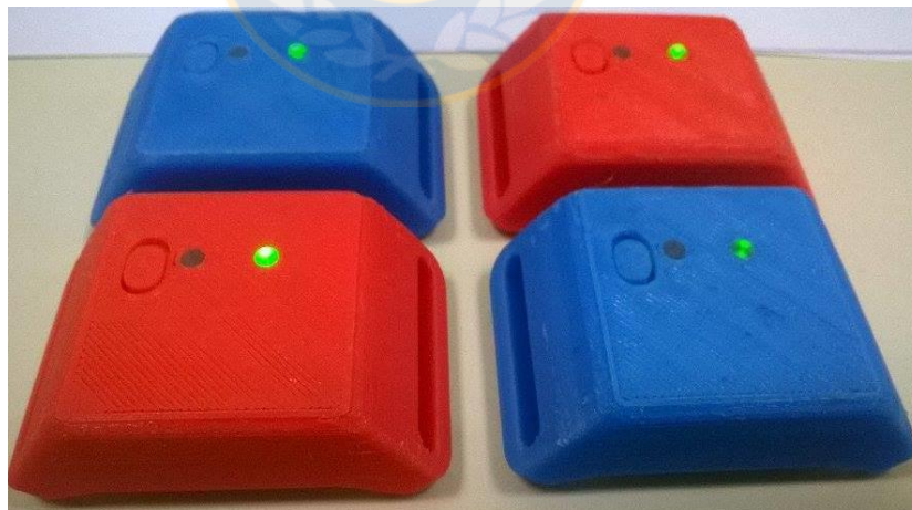
Figura 2.9. Carcasa impresa con tecnología de impresión 3D en dos colores. Fuente:
