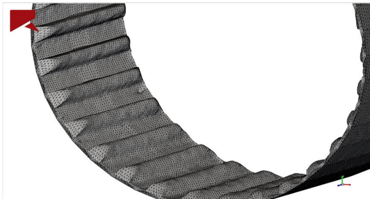
Figura C.2 Geometría de alzadores tras 55 segundos transcurridos en simulación (Fuente: Elaboración propia).
