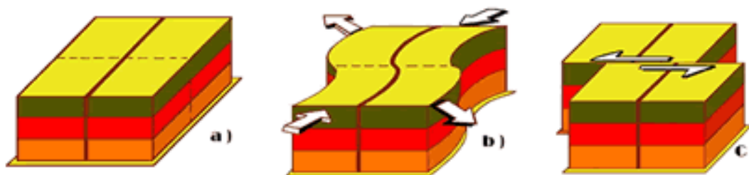
Figura 8: Ciclo de acumulación y liberación de esfuerzos. A) Reposo B) Deformación C) Relajación
