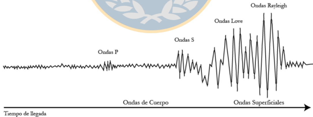
Figura 15: Registro en un sismograma de la llegada de las ondas internas y superficiales a un emplazamiento
