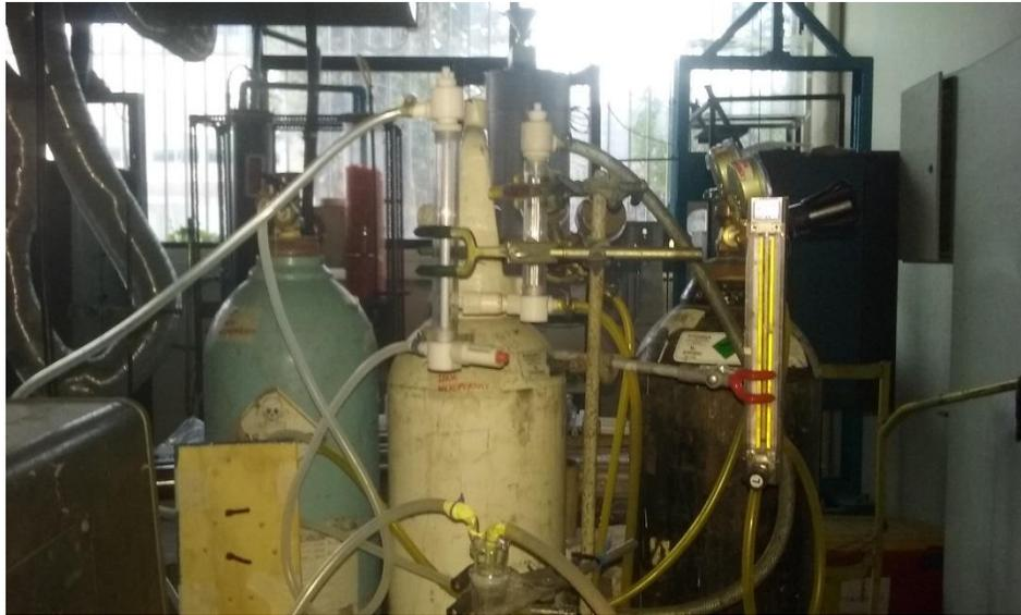
Figura 25: Bombonas de gases con sus rotámetros.
