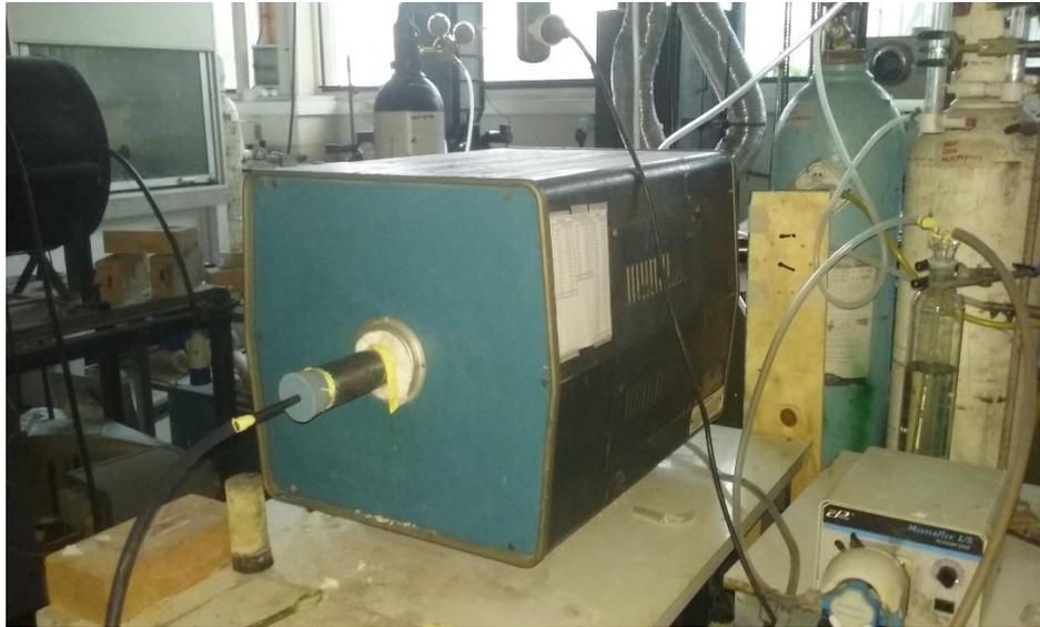
Figura 23: Horno y cámara de reacción (salida de gases).
