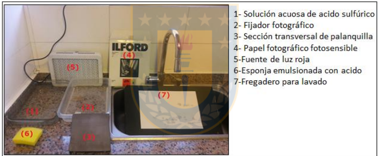
Figura 16. Equipamiento para realizar impresiones de Baumman
