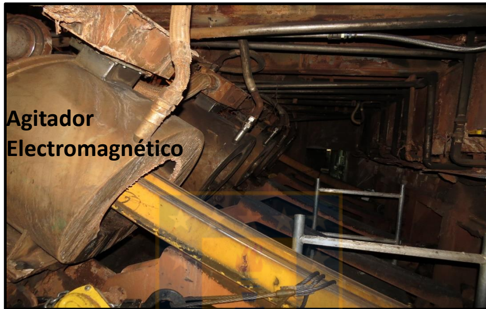
Figura 10. Agitadores de hebra instalados en la máquina de colada continua.
