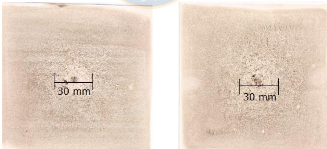
Figura 35. Impresiones de Baumman en secciones transversales de acero alto carbono procesado a elevadas velocidades de colada continua.
