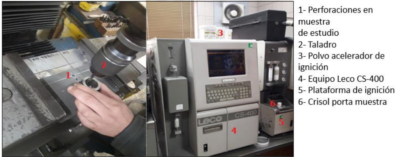
Figura 17. Esquema procedimiento para análisis de Carbón y Azufre
