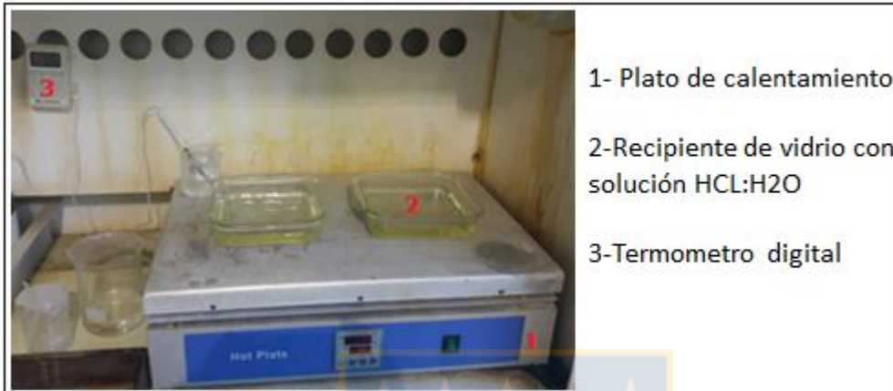
Figura 14. Equipamiento para realizar macro impresión con ácido clorhídrico
