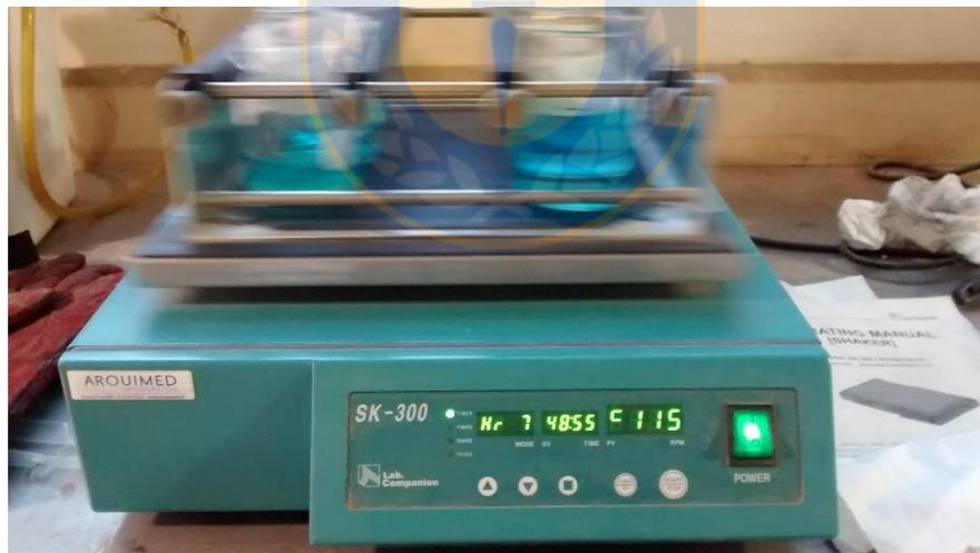
Figura 9: Agitador Shaker en funcionamiento para prueba de Isoterma de Extracción.
