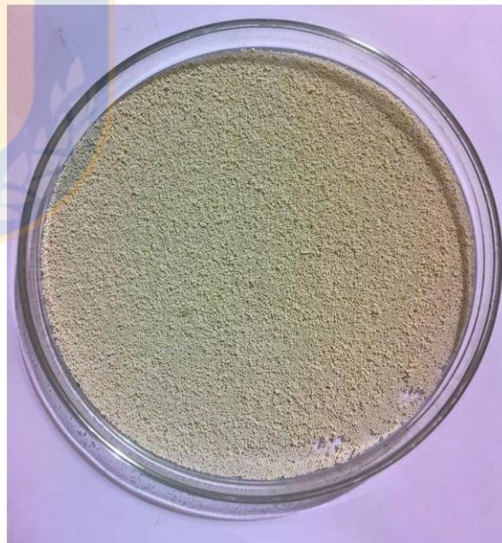
Figura 10: Resina de intercambio iónico.
