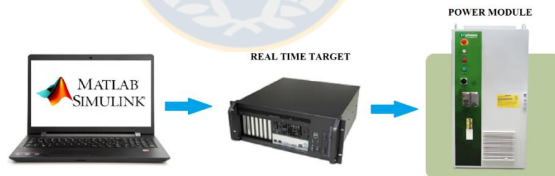
Fig. 4.5 Esquema de comunicación para operar el convertidor Triphase
