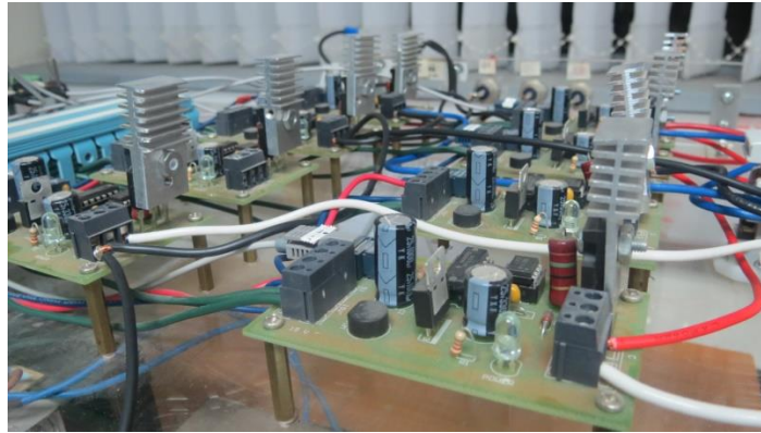
Fig. 4.18 Inversor usado en la etapa activa del filtro híbrido
