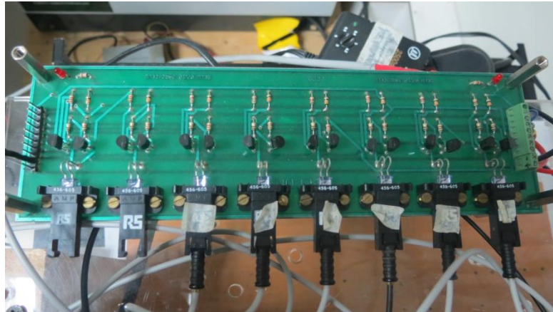
Fig. 4.15 Tarjeta eléctrica/óptica para generar pulsos de disparo de los IGBT
