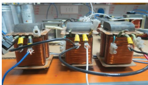
Fig. 4.25 Transformadores de acoplamiento implementados en el setup experimental Fuente: Elaboración propia.
