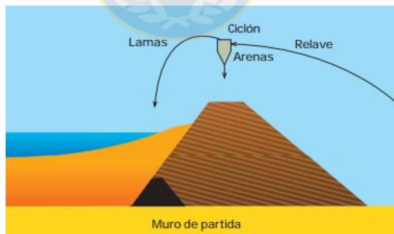
Figura 3.2: Construcción del muro (3).
