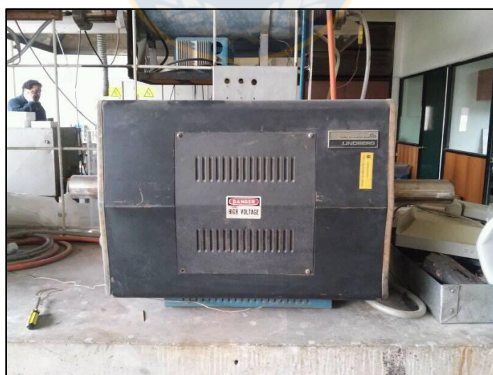
Figura 11. Horno horizontal Lindberg con tubo de reacción de acero inoxidable.
