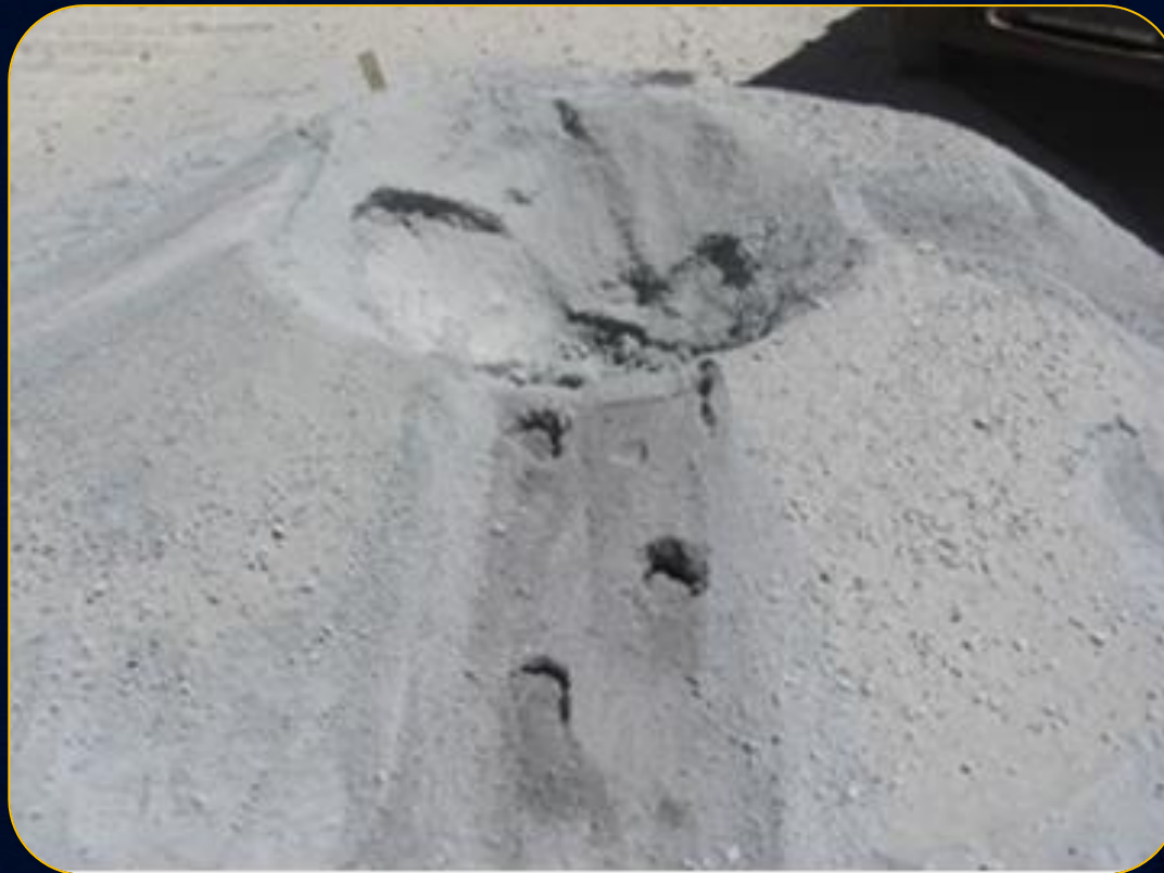
Figura 29. Muestreo siguiendo el protocolo de muestreo de blast hole (Fuente: Elaboración Propia).
