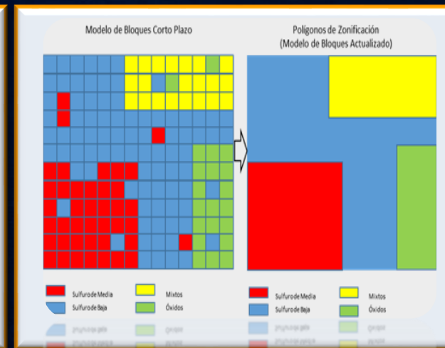
Figura 5. Representación de una mineralización como zonificaciones minerales utilizando el modelo de bloques de corto plazo y su influencia en la Dilución Planificada (Fuente: Elaboración Propia).
