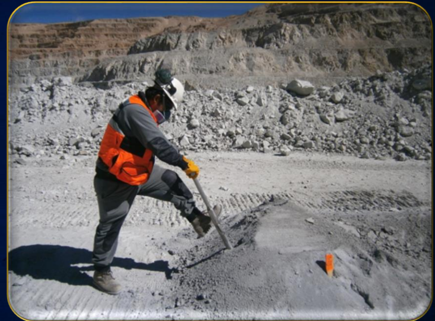
Figura 9. Muestreo de pozos de tronadura con tubos en mallas de perforación (Fuente: Elaboración Propia).
