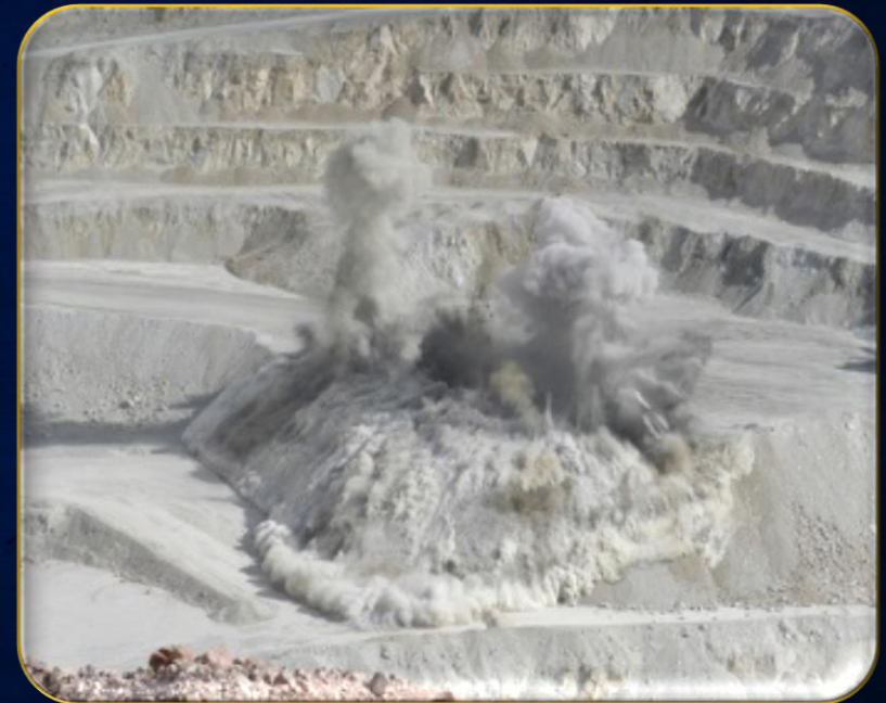
Figura 16. Desplazamiento por tronadura en una malla de producción (Fuente: Elaboración Propia).
