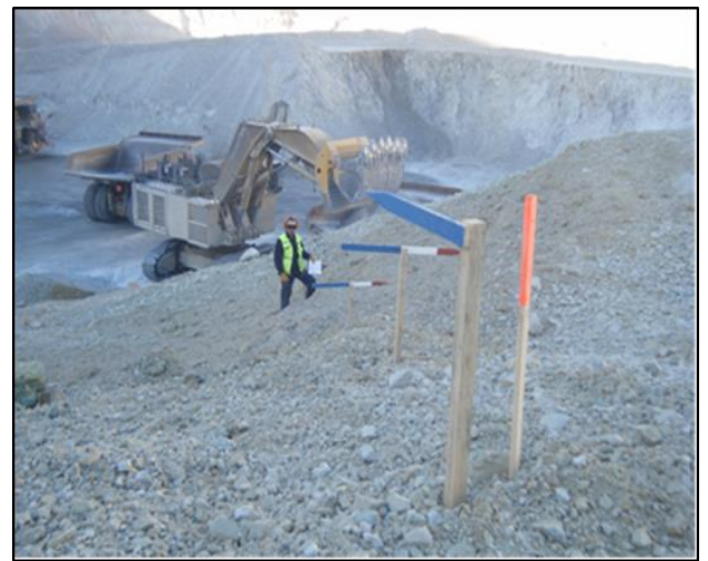
Figura 6. Control de polígonos de extracción por marcación con estacas
