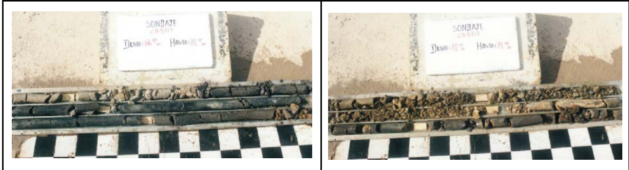
Fotografía 5.6. Tramo del sondeaje CH5717, desde los 70,50 m hasta los 73,50 m, caracterizado con una muy baja resistencia en el contacto entre las unidades Granodiorita Elena Sur y Metasedimentos.
