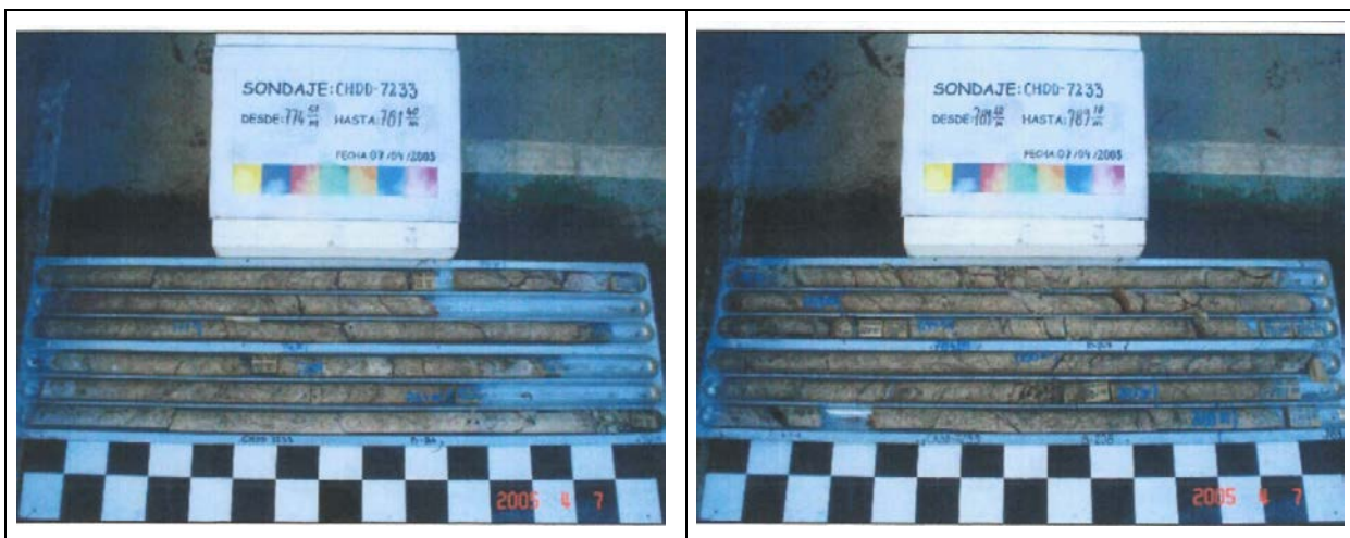
Fotografía 5.2. Tramo del sondaje CHDD7233, desde los 774,81 m hasta los 789,10 m, caracterizado con una alta resistencia y una buena calidad geotécnica en la UGTB Granodiorita Fortuna.
