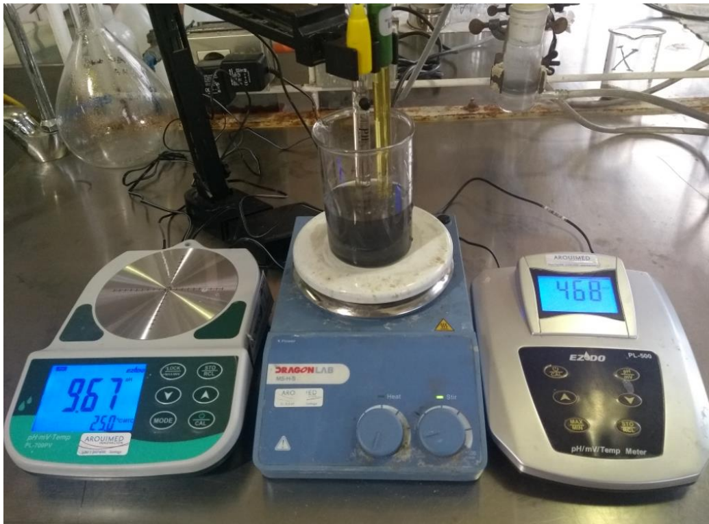
Figura 26. Acondicionamiento previo a pruebas de micro-flotación
