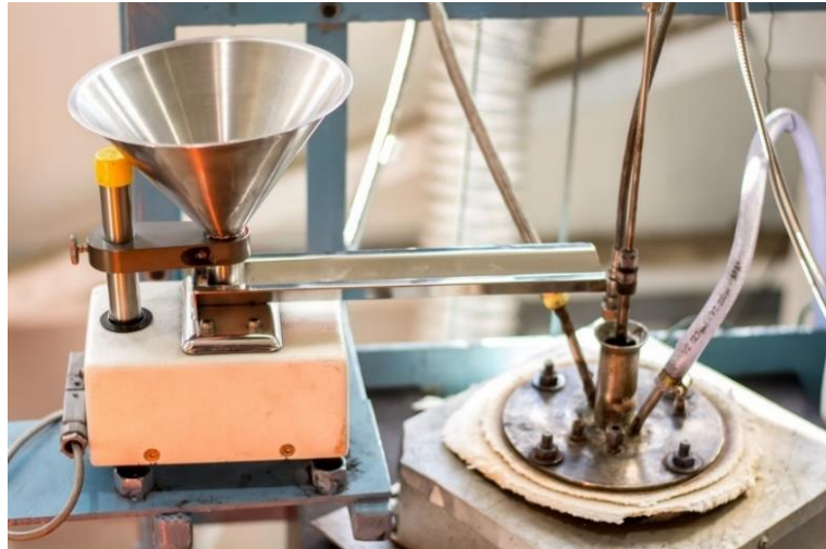
Figura 7: Montaje del alimentador vibratorio de laboratorio FRITSCH® con canaleta tipo V en entrada de lanza de alimentación.
