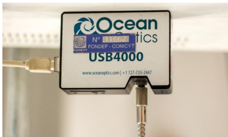
Figura 9: Montaje espectrómetro Ocean Optics USB4000.
