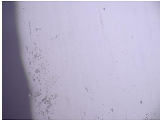
Figura 29: Micrografía con aumento x200 electrodo AISI 316L afectado por corrosión localizada.
