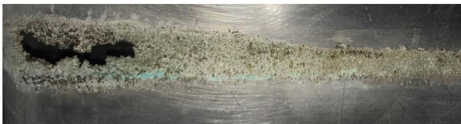
Figura 1: Perforación en cátodo AISI316L producto de corrosión localizada.
