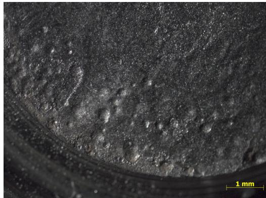
Figura 36: Micrografía realizada a muestra de acero AISI316L empleada para condición A a 35453 ppm de cloruro.
