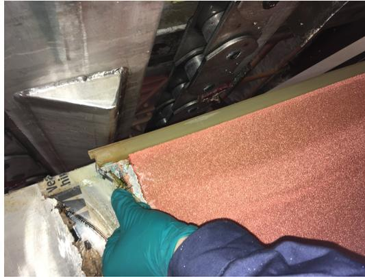
Figura 58: Cátodo afectado por corrosión localizada y formación de acreciones en su superficie (c).
