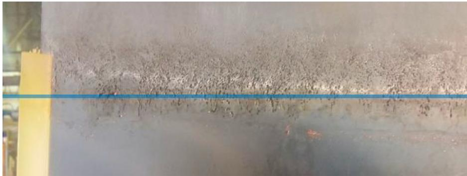
Figura 3: Cátodo 316L afectado por corrosión localizada en la región superior a la línea que delimita la sección sumergida [2].
