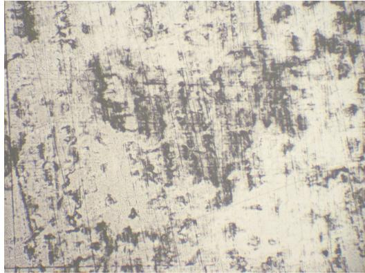
Figura 28: Micrografía con aumento x200 de electrodo AISI 316L afectado por corrosión generalizada.
