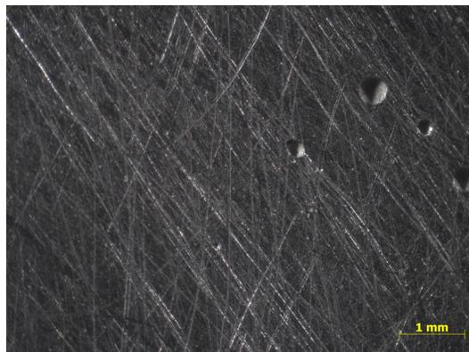
Figura 41: Micrografía realizada a muestra de acero AISI316L empleada para condición B a 150 ppm de cloruro.
