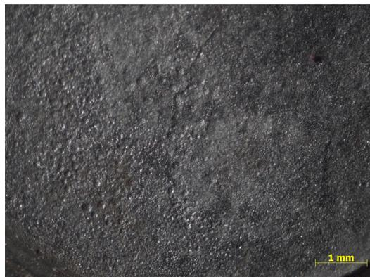
Figura 34: Micrografía realizada a muestra de acero AISI316L empleada para condición A a 28362 ppm de cloruro.
