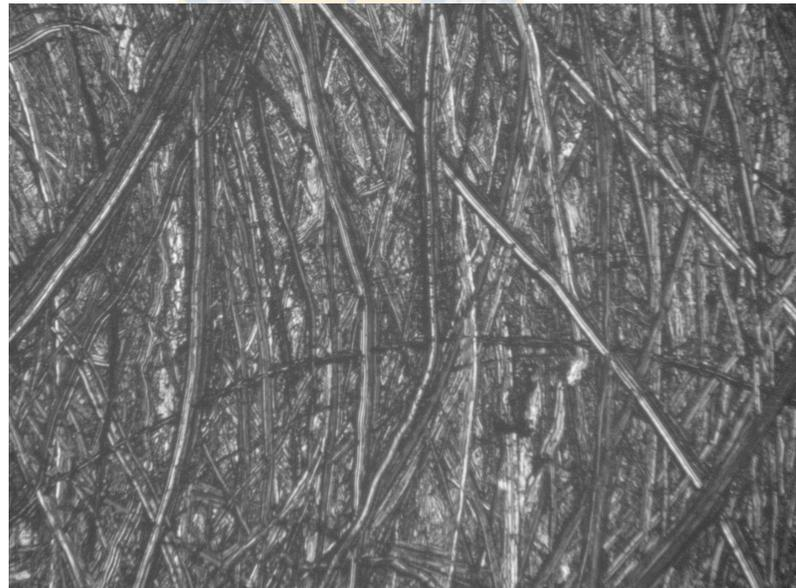
Figura 21: Micrografía con aumento x200 de la condición superficial representativa de los electrodo de acero AISI 316L empleados para la prueba B.
