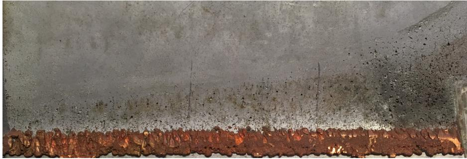
Figura 2: Corte de cátodo AISI316L afectado por corrosión localizada e inclusiones de cobre en su superficie.
