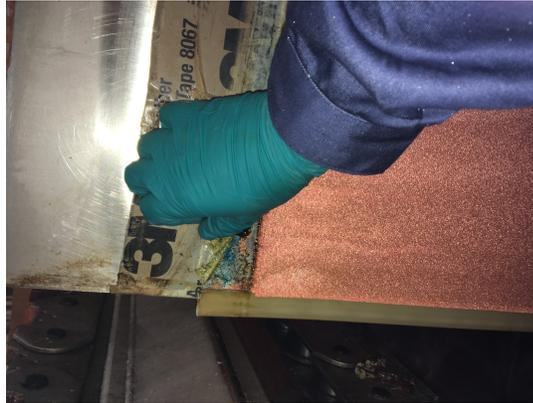
Figura 56: Cátodo afectado por corrosión localizada y formación de acreciones en su superficie (a).
