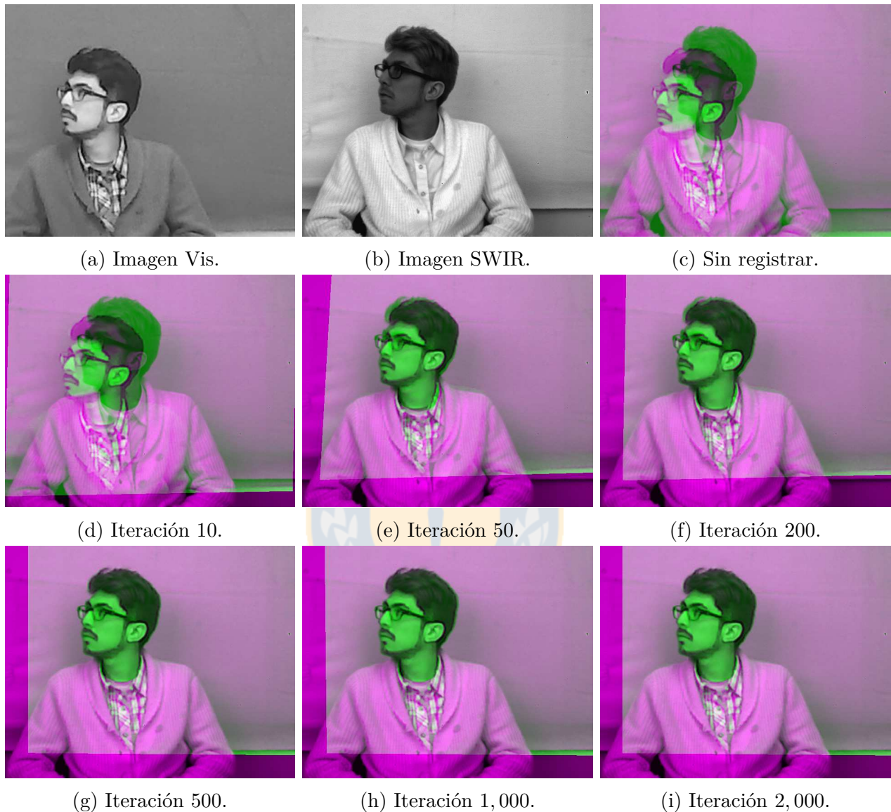
Figura 5.3: Registro Vis-SWIR utilizando información mutua, imagen 1. Fuente: Elaboración propia.
