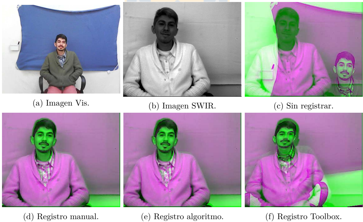
Figura 5.11: Comparación registro Vis-SWIR, imagen 3. Fuente: Elaboración propia.
