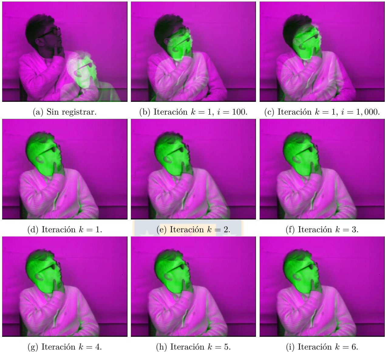
Figura 5.17: Registro SWIR-LWIR utilizando el algoritmo propuesto, imagen 2. Fuente: Elaboración propia.
