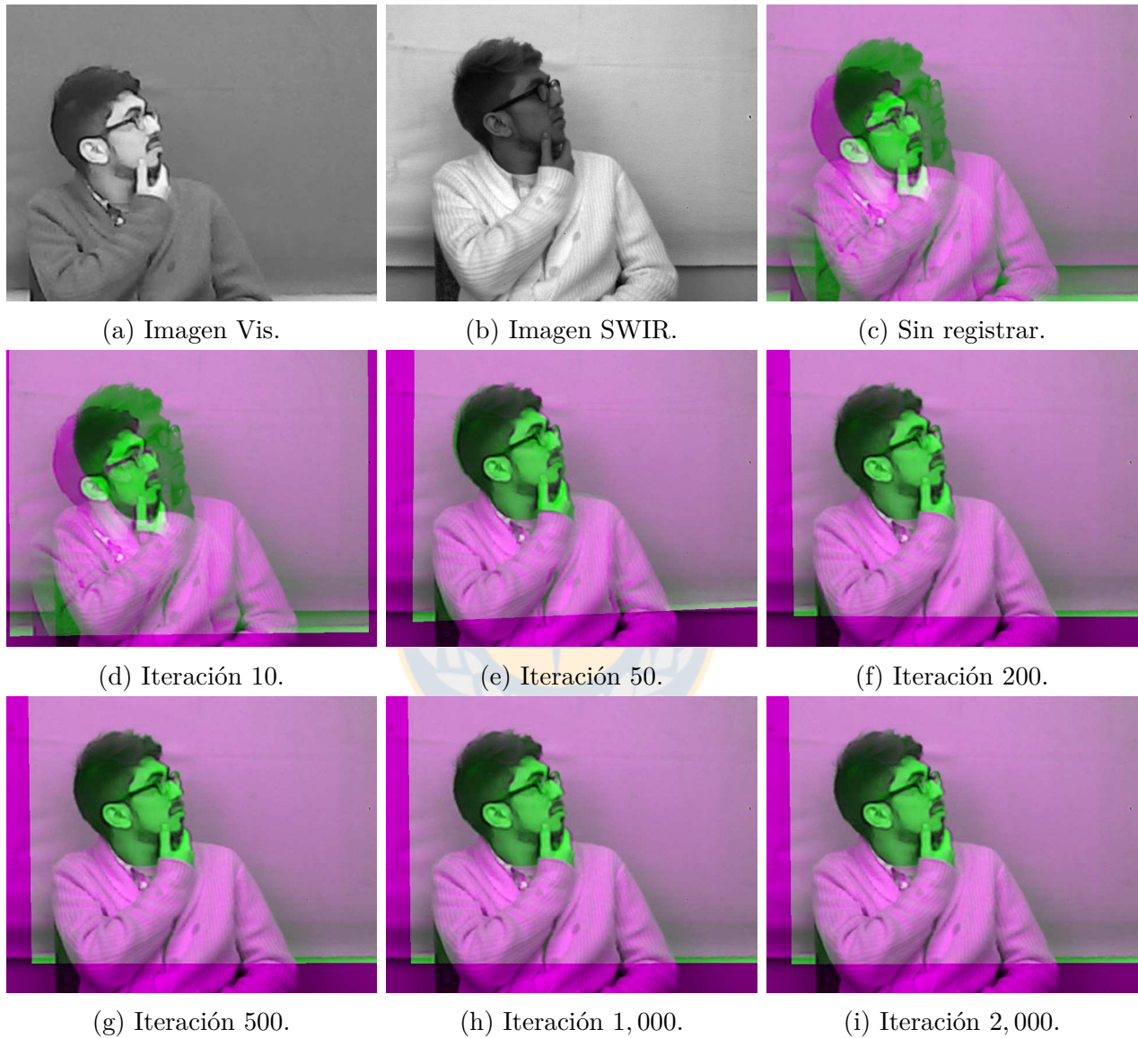
Figura 5.4: Registro Vis-SWIR utilizando información mutua, imagen 2. Fuente: Elaboración propia.
