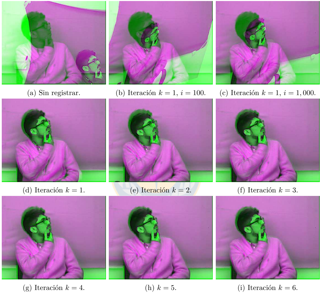
Figura 5.7: Registro Vis-SWIR utilizando el algoritmo propuesto, imagen 2. Fuente: Elaboración propia.
