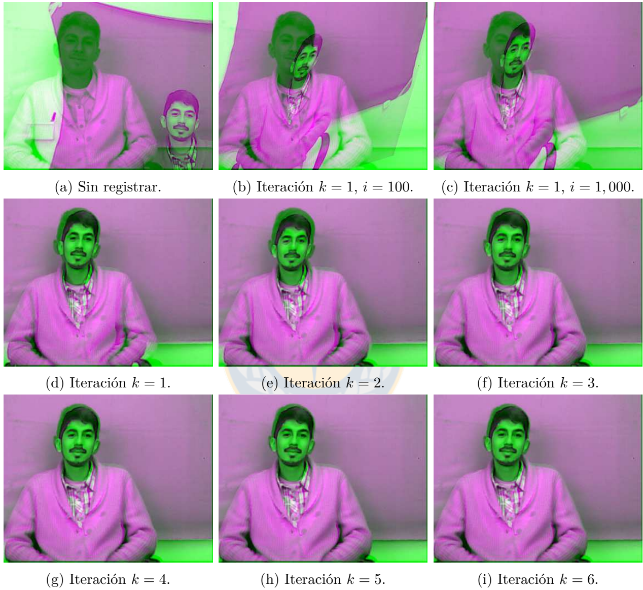
Figura 5.8: Registro Vis-SWIR utilizando el algoritmo propuesto, imagen 3. Fuente: Elaboración propia.
