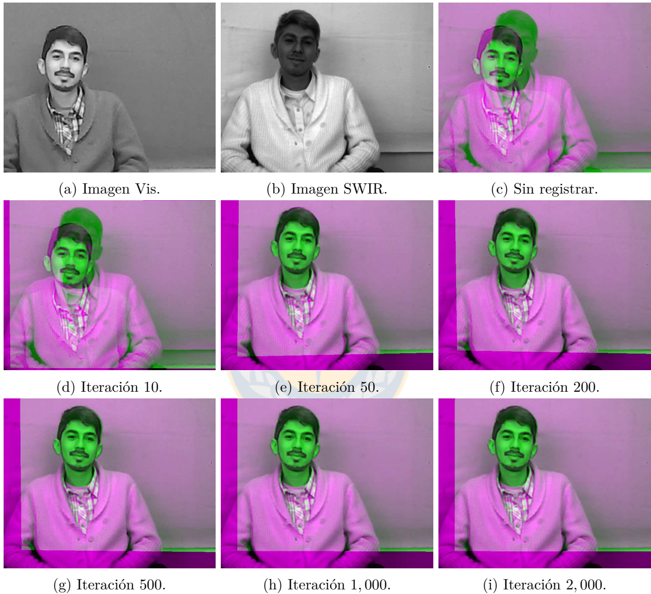
Figura 5.5: Registro Vis-SWIR utilizando información mutua, imagen 3. Fuente: Elaboración propia.
