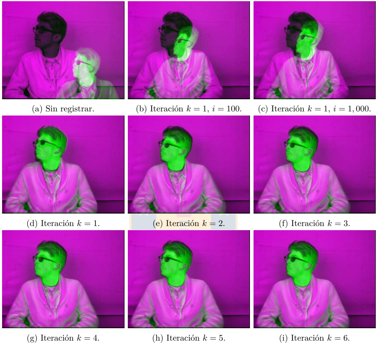
Figura 5.16: Registro SWIR-LWIR utilizando el algoritmo propuesto, imagen 1. Fuente: Elaboración propia.
