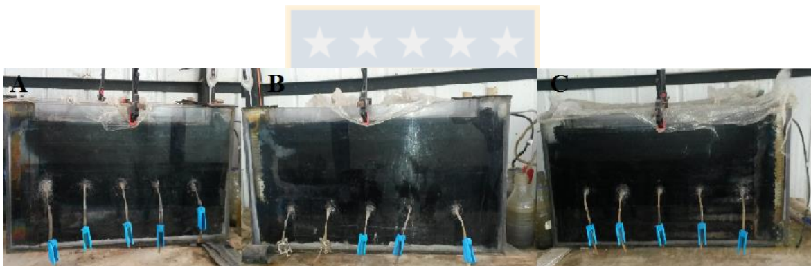
Figura A. 4. Perforaciones para los puntos de muestreo en los reactores R 2.5 A, R 5 A y R 7.5 A (Fuente: Elaboración propia).
