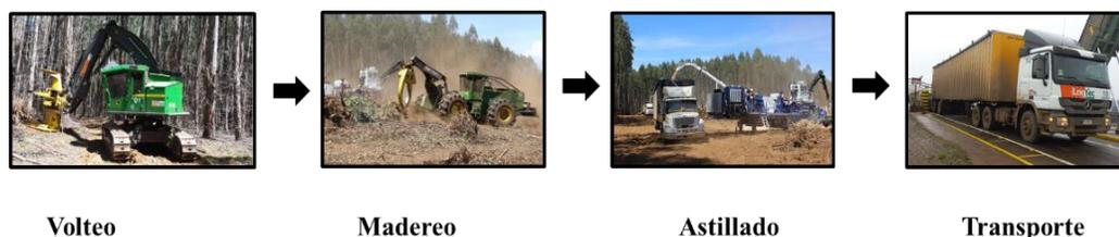
**Figura 4.** Proceso de cosecha forestal mecanizada.
