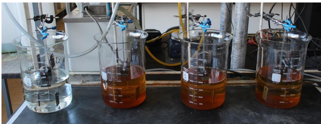
Figura 17. Montaje experimental del test de inmersión.
