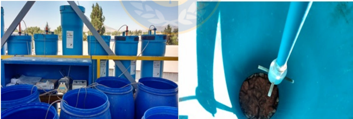
Figura 8. Sistema de bombeo y riego columnas. Fuente: Elaboración propia
