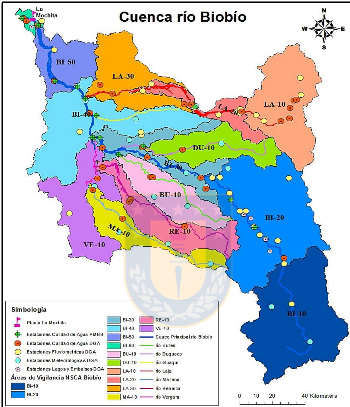
**Figura 13. Red Hidrometeorológica y de Calidad de Aguas DGA, estaciones calidad de agua PMBB EULA-Chile y áreas de vigilancia NSCA Biobío, junto a sus principales subcuencas.**
