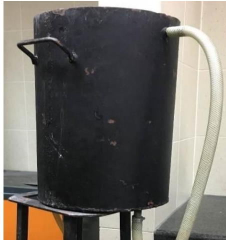
Figura 48 Permeámetro usado para medir la permeabilidad.
