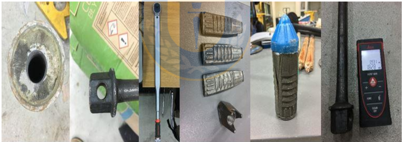
Figura 46 (izquierda a derecha: núcleo, cabeza del perno, torquímetro, hojas de la cámara de expansión, cámara armada, largo total del perno).
