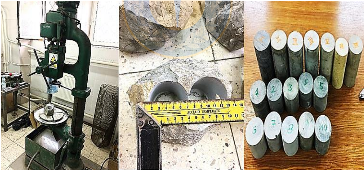
Figura 57 Obtención de muestras (izquierda: perforadora, centro y derecha: testigos).
