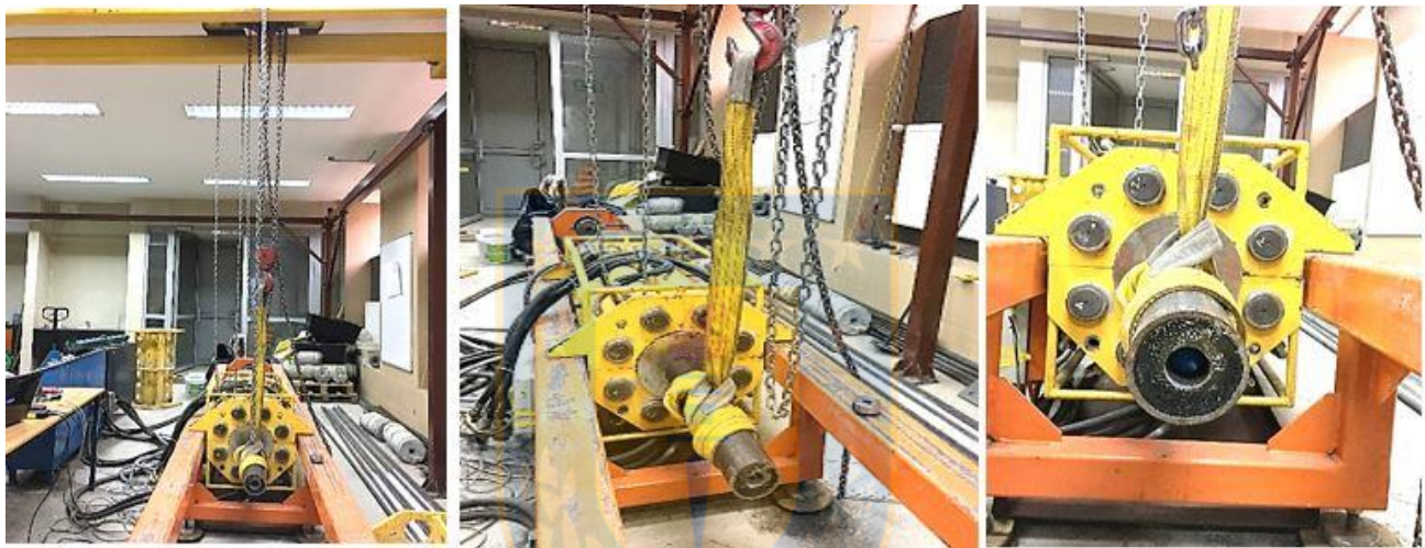
Figura 47 Perno instalado en el equipo de medición de carga (distintos ángulos).
