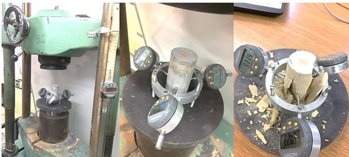
Figura 45 Testigo de roca, junto a relojes comparadores, durante el ensayo de medición.
