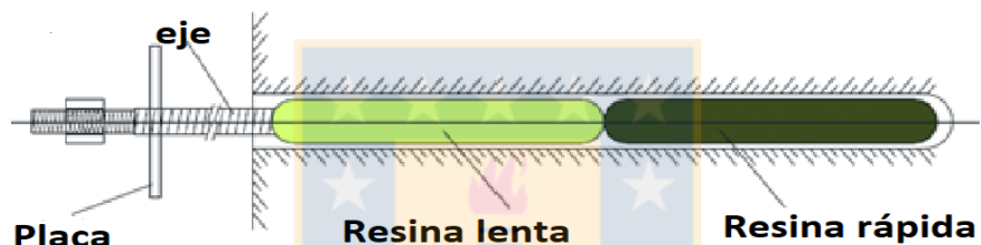
Figura 6a Perno de varilla inyectado con resina.
