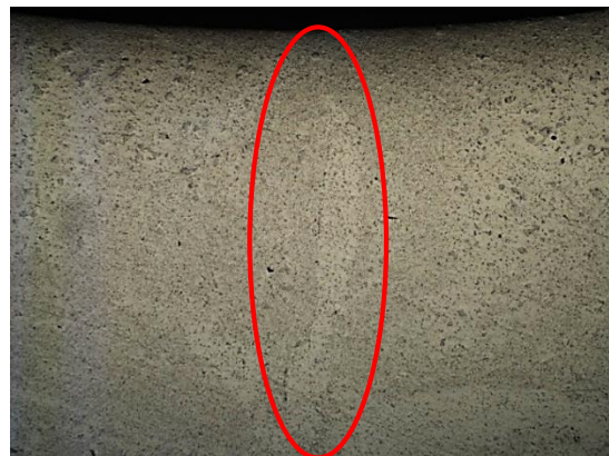
Figura 4.11. Metalografía de zona de soldadura de tubo obtenido por extrusión directa, con tratamiento térmico de envejecido a 175°C por 8 horas, con ataque químico, 50x
