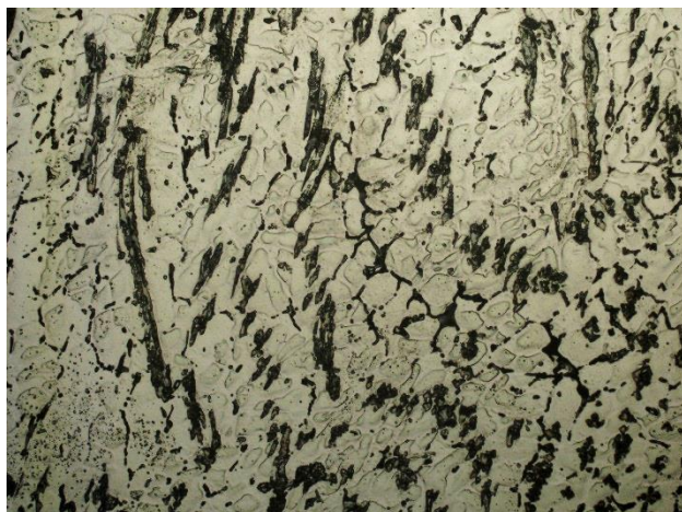
Figura 4.4. Metalografía de Tubo a 200x, con tratamiento térmico de envejecido a 175°C por 8 horas y ataque químico. 200x
