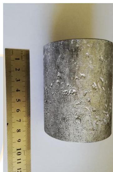
Figura 3.4. Tocho obtenido por rheocasting para extrusión directa.
