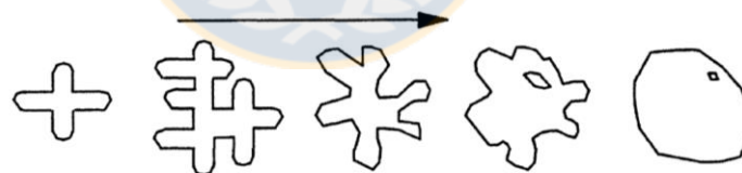
Figura 2.5. Evolución microestructural de dendrita a roseta debido a la agitación del baño fundido [15]
