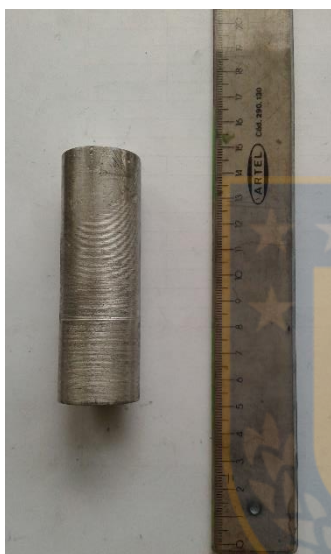
Figura 3.3. Tocho obtenido por rheocasting para extrusión inversa.
