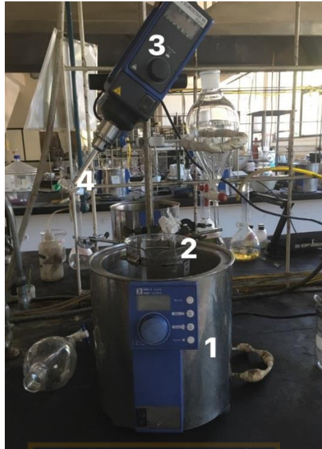
Figura 9. Reactor para las pruebas de equilibrio de extracción y re-extracción. 1: Baño termostático, 2: Vaso de precipitado de 1L de capacidad, 3: Agitador mecánico, 4: Impulsor de vidrio con 4 aspas.
