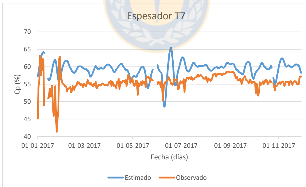
Figura 27. Valores simulados y observados de C_p para espesador T7, con datos eliminados.
