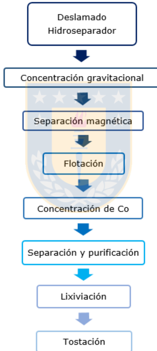
Figura 3.13: Diagrama de flujo recuperación cobalto en relaves [14].
