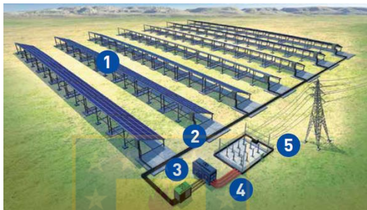
Figura 4. Parque solar fotovoltaico con sus cinco componentes principales, (1) estructuras soportantes, (2) sistemas de cables y conectores eléctricos, (3) inversores, (4) transformadores y (5) estación eléctrica [6].
