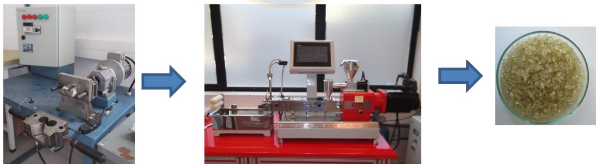
Figura 3.2. Etapas de procesamiento para obtención de ATP (mezcladora-extrusora-muestra de pellet ATP). Fuente: elaboración propia.
