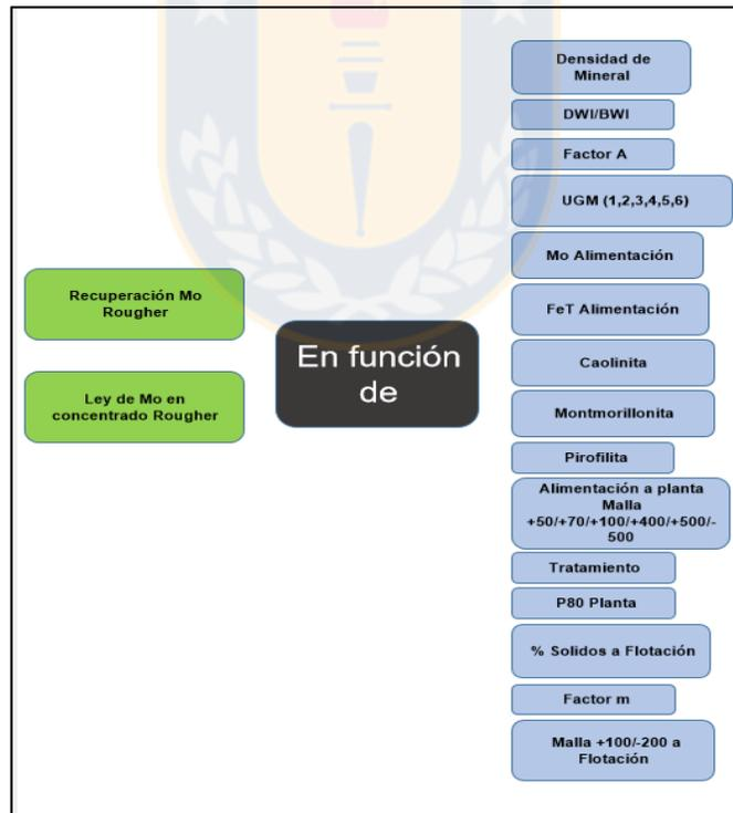
Figura 30. Parámetros evaluados en flotación rougher.
