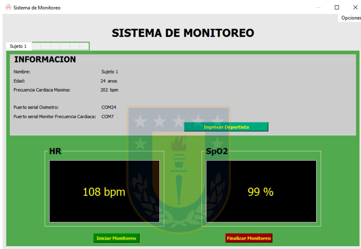
Fig. 4.7 Interfaz de Visualización del Sistema de Monitoreo en funcionamiento.
