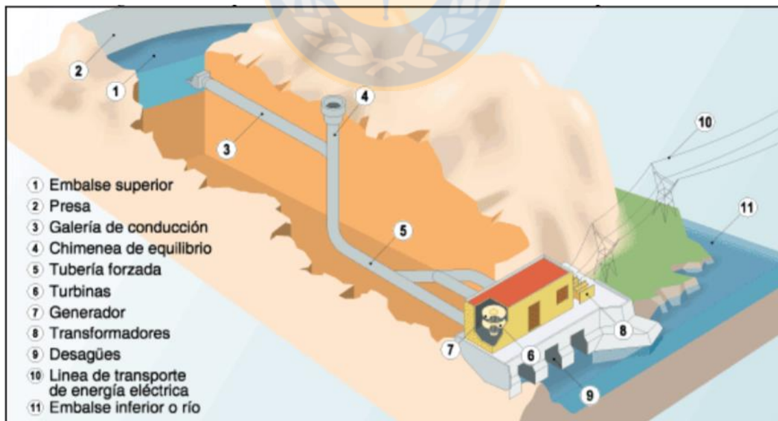
Figura 4: Principales componentes de una central hidroeléctrica de bombeo (CHB).
