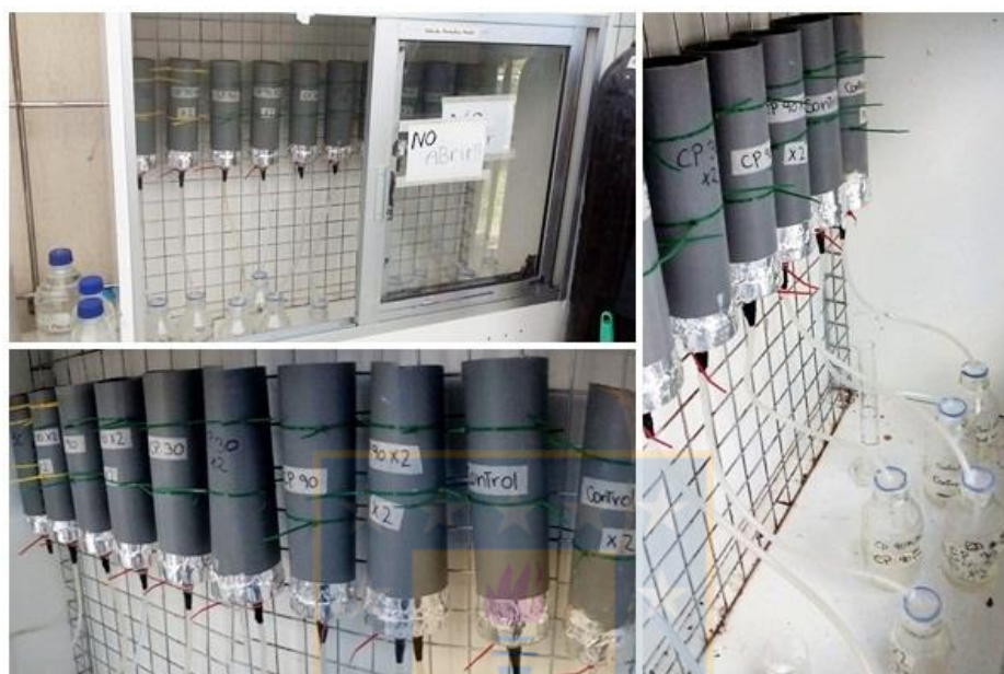
Figura 10. Columnas de suelo instaladas.
