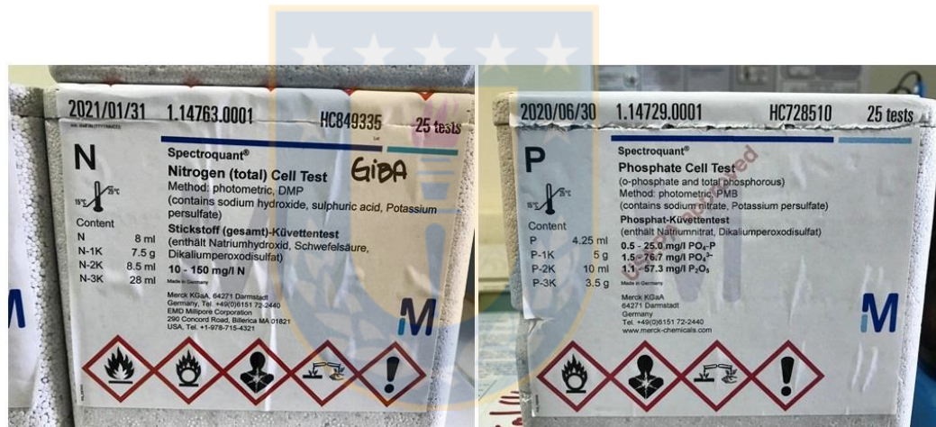
Figura 13. Test de cubeta SPECTROQUANT para nitrógeno total (izquierda) y fósforo total (derecha).
