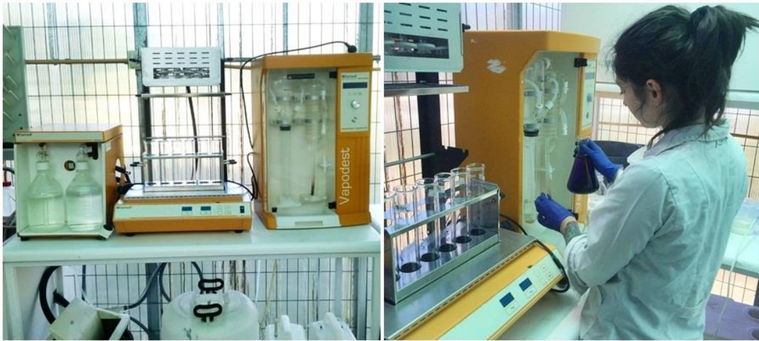
Figura 14. Equipo utilizado en la medición de nitrógeno total kjledahl.
