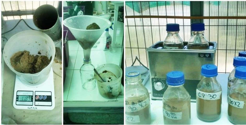
Figura 12. Proceso de desmonte de columnas de suelo utilizadas y preparación para análisis finales.
