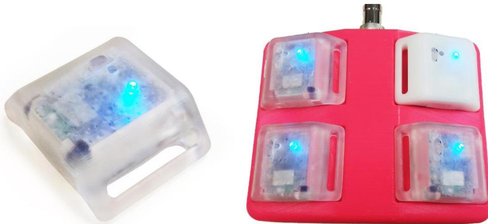
Fig. 4.1 Unidad de medición inercial y su plataforma de carga inalámbrica.
