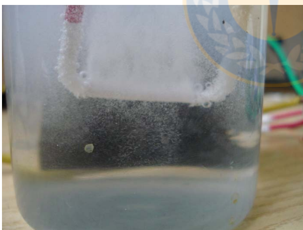
Fotografía 3: Celda en régimen propio de etapa 2, que considera electrólisis de agua y formación de vapor por efecto Joule en el electrodo objetivo (cobre)
