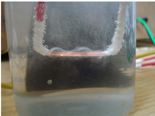
Fotografía 4: Celda en etapa 3, bajo régimen de plasma electrolítico; se observa el electrodo objetivo recubierto de gas y las descargas puntuales de plasma
