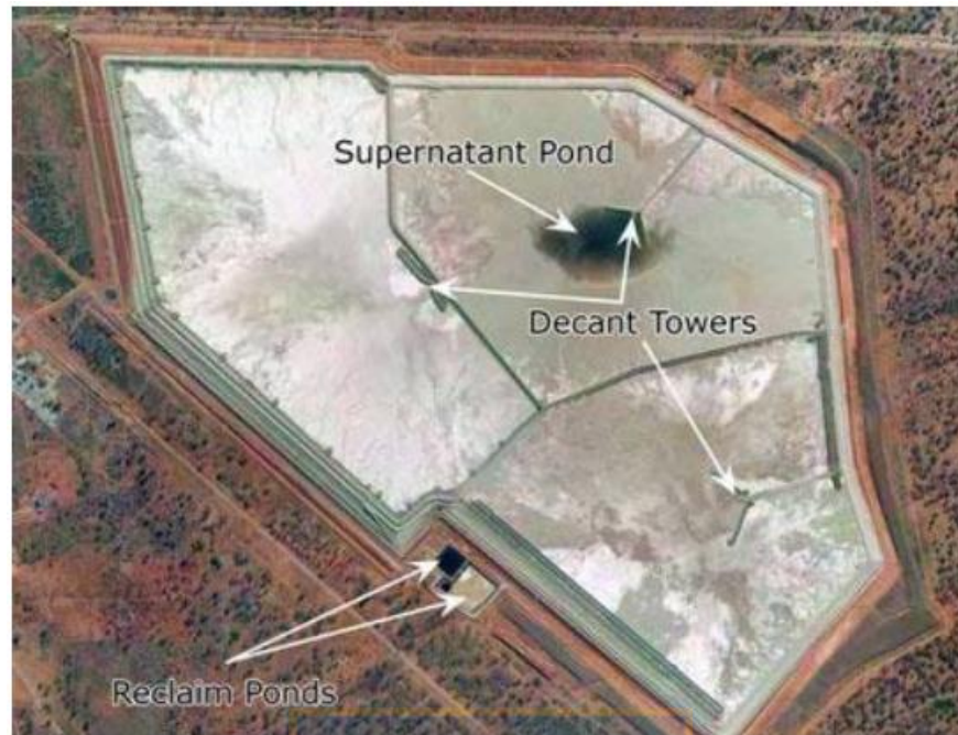
Figura 8.1 Relave dispuesto con el método dique de anillo en Kalgoorlie Consolidated Gold Mines (Álvarez, 2017).
