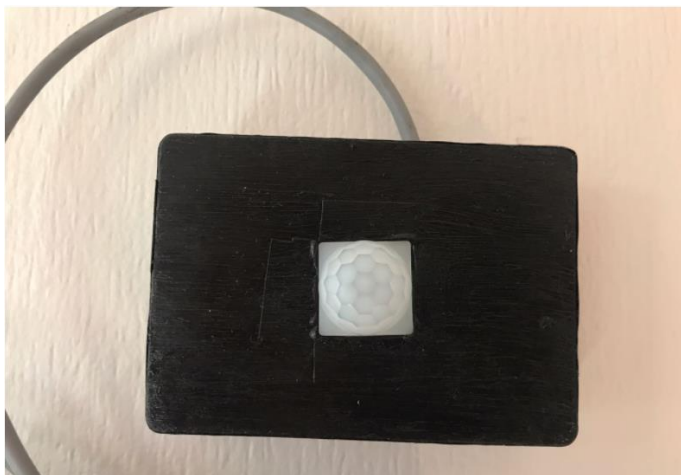
Fig. 7.3 Tablero para el sensor de movimiento en su etapa final.
