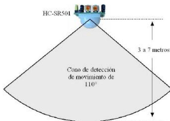
Fig. 5.4 Rango de detección de movimiento de los sensores PIR. [27]
