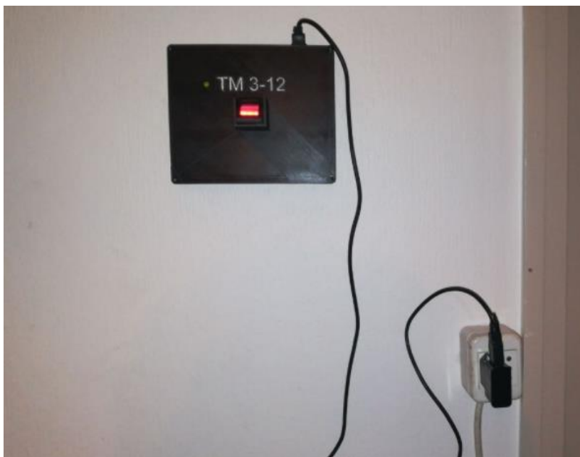
Fig. 7.10 Sistema de registro de asistencia a clases mediante el uso de lector de huella dactilar en funcionamiento a la espera de una huella dactilar.
