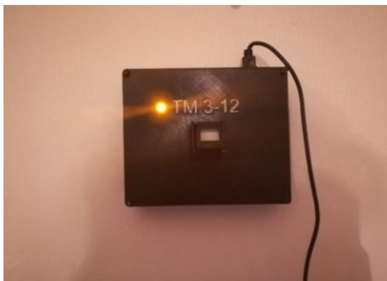
Fig. 7.11 Sistema de registro de asistencia a clases mediante el uso de lector de huella dactilar en funcionamiento al momento de reconocer una huella dactilar dentro de su memoria (enciende la luz LED).
