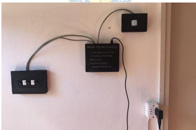
Fig. 7.4 Sistema de presencia académica utilizando sensor de movimiento implementado en su etapa final.
