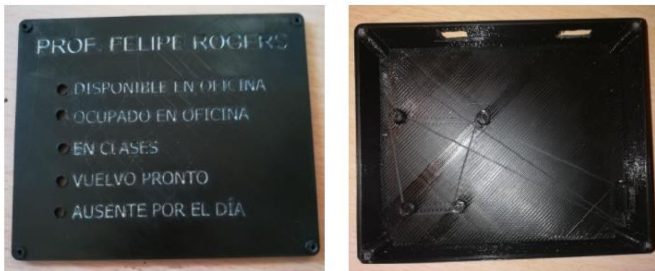
Fig. 5.14 Vista frontal y lateral de la tapa del tablero de presencia académica impreso.
