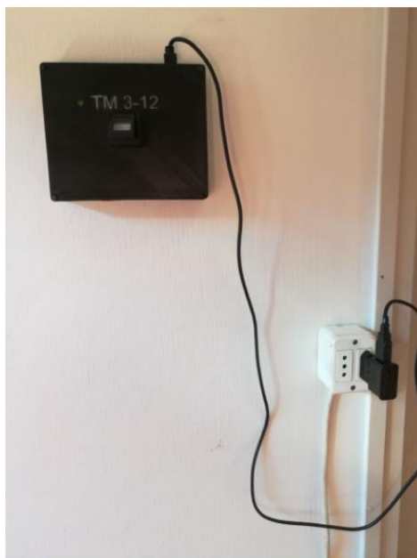
Fig. 7.8 Sistema de registro de asistencia a clases mediante el uso de lector de huella dactilar implementado en su etapa final.
