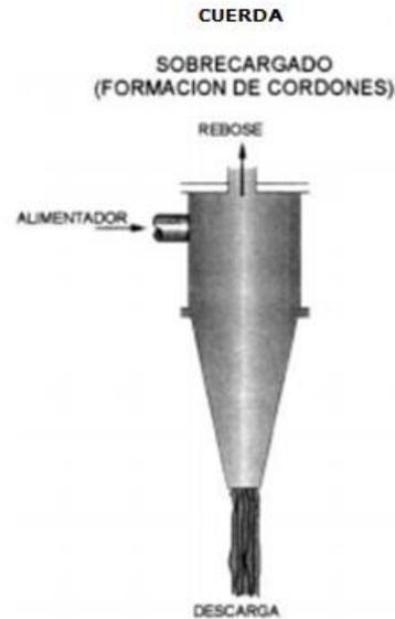
Figura 19: Descarga tipo cuerda [15].
