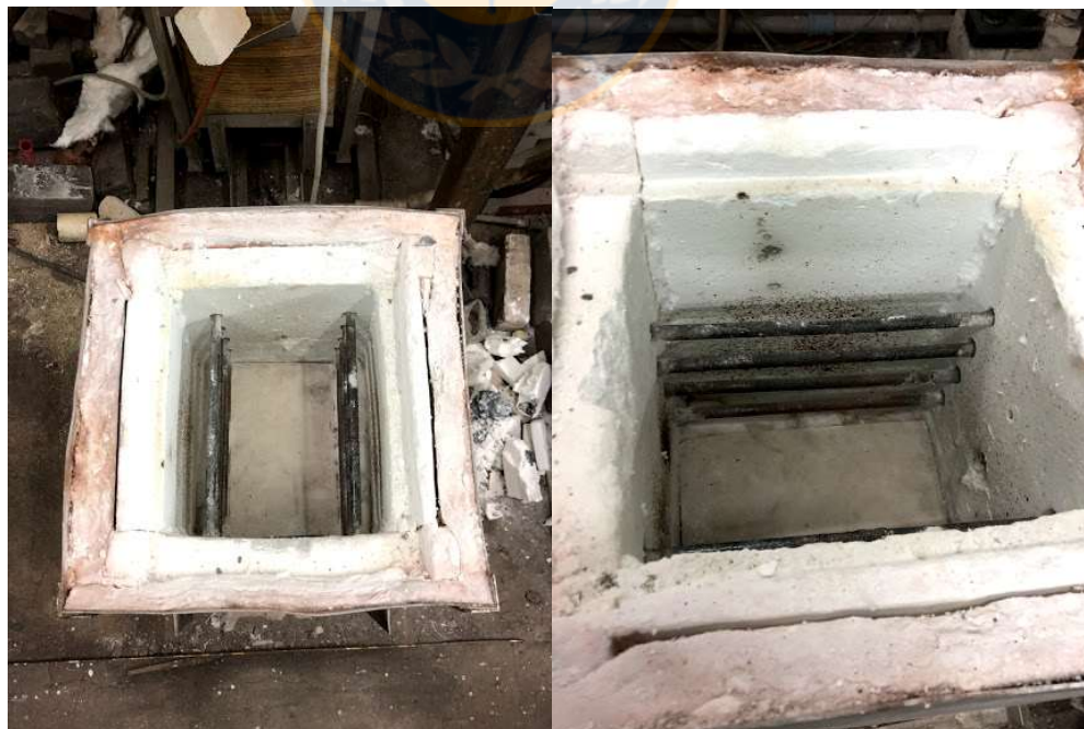
Figura 17: Horno eléctrico utilizado para el calentamiento de las muestras.
