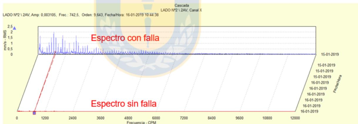
Espectro en cascada de velocidad, mediciones previa y posterior al cambio
