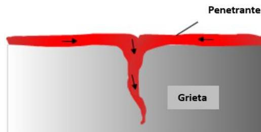
**Figura 22 Ingreso del penetrante en una discontinuidad**
