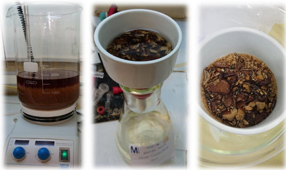
Figura 9. Síntesis macromonomero GGM-MA, lavado con etanol(a) y filtrado(b).
