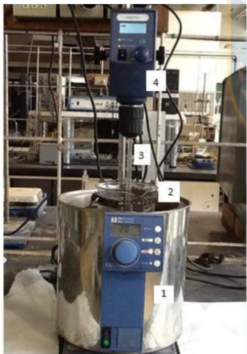
Figura 7: Equipamiento de las pruebas de extracción. 1: baño termostático, 2: reactor, 3: impulsor de vidrio de 4 aspas, 4: agitador mecánico.
