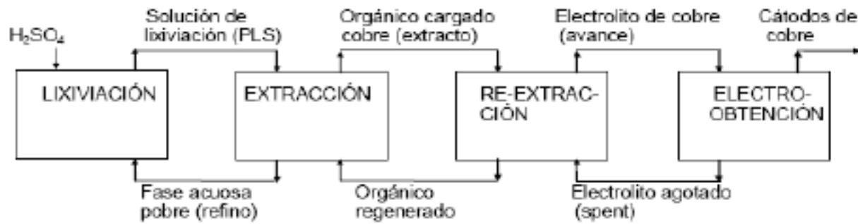
Figura 1: Recuperación de cobre mediante lixiviación- extracción por solventes- electrolisis. (Ruiz,2013)
