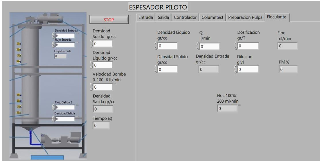
Figura 18. Pantalla de dosificación de floculante.
