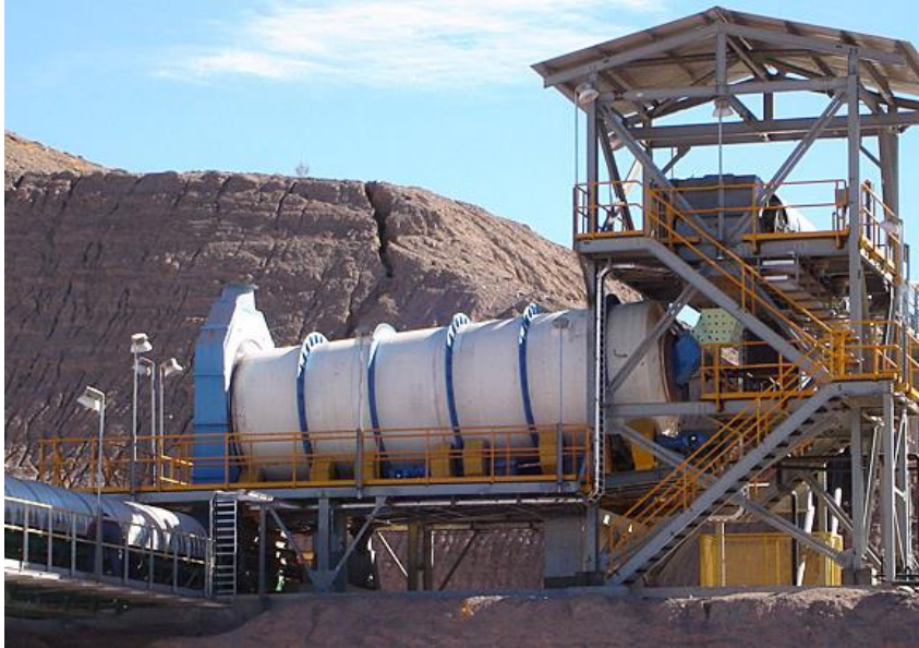
Figura 5. Representación característica de un tambor aglomerador. (ERAL-CHILE, S.A)
