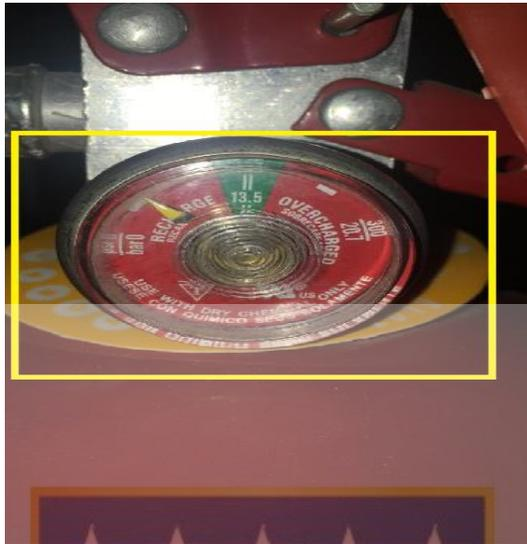
Figura 2. Aguja del manómetro del extintor portátil de incendio despresurizado.
