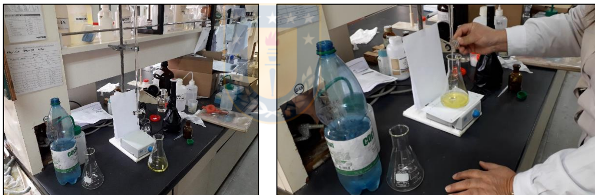
Figura 3.6: Procedimiento de titulación para determinación de cloruro. Izquierda: antes de la titulación. Derecha: titulación terminada.
