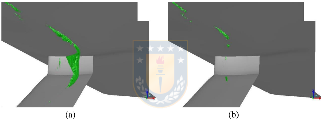
Figura A.45. Wave drag generado (Vista interna): (a) Sin AFC; (b) Con AFC. Fuente: [Elaboración Propia].
