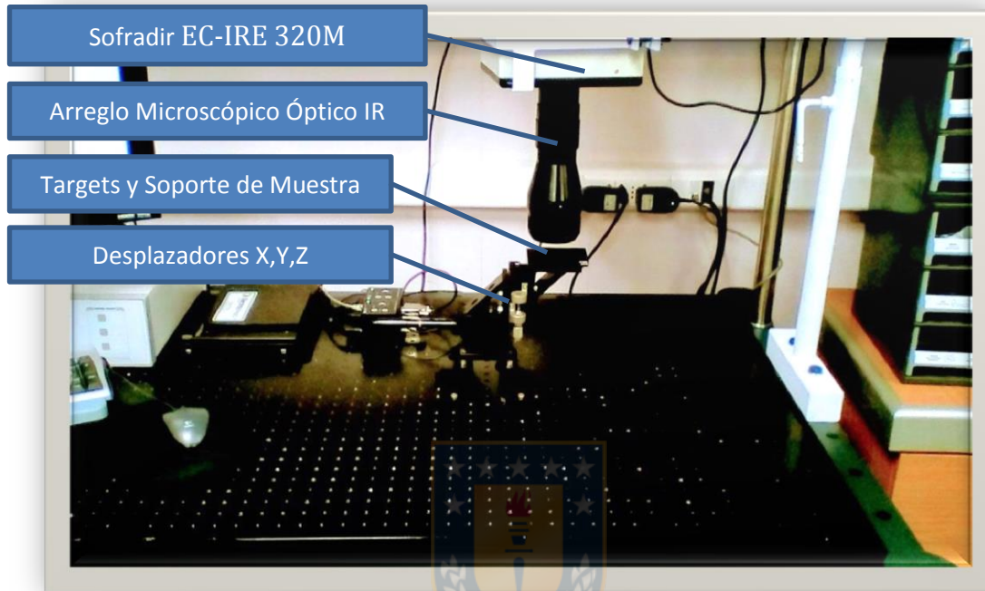
Figura 18, Configuración experimental para la adquisición de imágenes térmicas microscópicas. Los desplazadores en los ejes x, y, z proveen condiciones de movimiento y enfoque relativas a la muestra. Esto permite capturar imágenes con un amplio rango de profundidad de campo.
