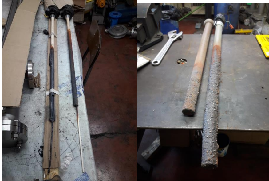
Figura 3.2.9 Termocuplas expuestas a los gases (Fotos Tomadas en Terreno)
