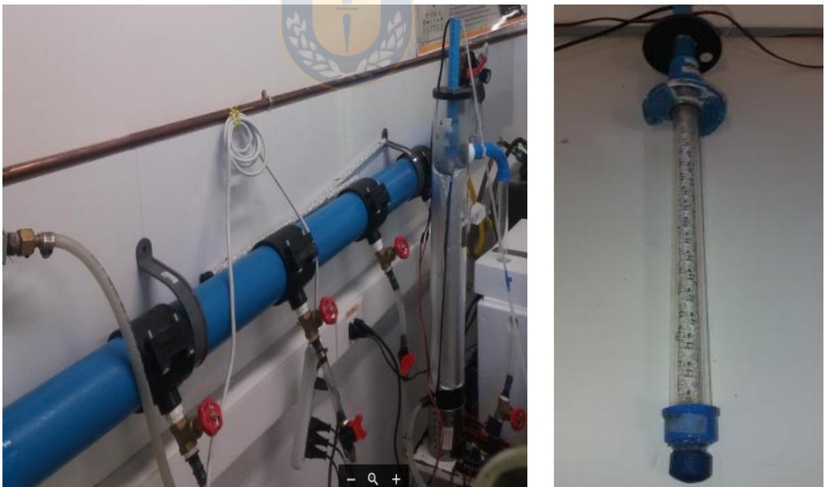
**Figura 6** A la izquierda, sistema de acumulación de aire que dirige el aire hacia la tubería del sistema de iluminación que, además, está asociado al sistema de aireación que culmina en el difusor el cual entrega las burbujas al sistema como se muestra en la imagen de la derecha.
