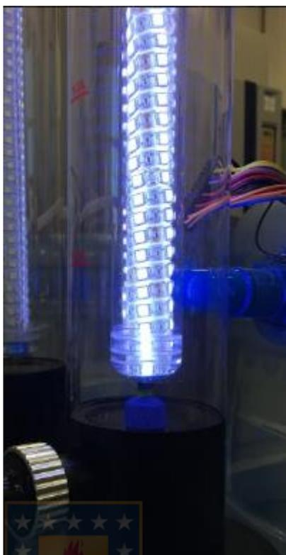
**Figura 4 Sistema de iluminación ubicado dentro del reactor, unido al sistema de aireación.**
