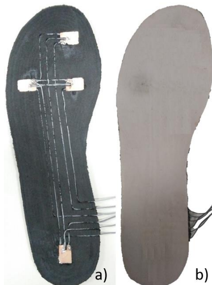
Fig. 3.4: Plantilla sensorizada implementada. a) Vista descubierta b) Vista cubierta
