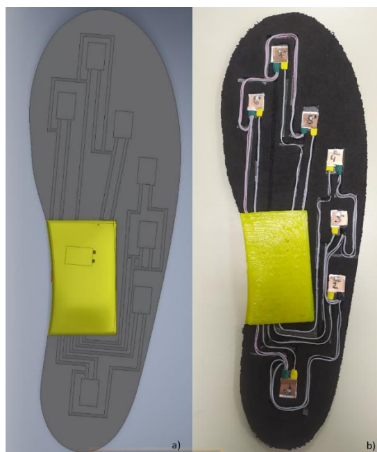
Fig. 3.3.6 Plantilla de calzado utilizada en pruebas finales, en amarillo contenedor de circuito. a) Diseño de plantilla b) Vista descubierta de plantilla con sensores embebidos.
